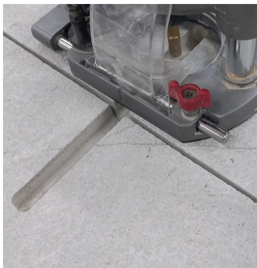
1. Создание пропила для установки дюбеля (диаметр фрезы 8,3 мм)
